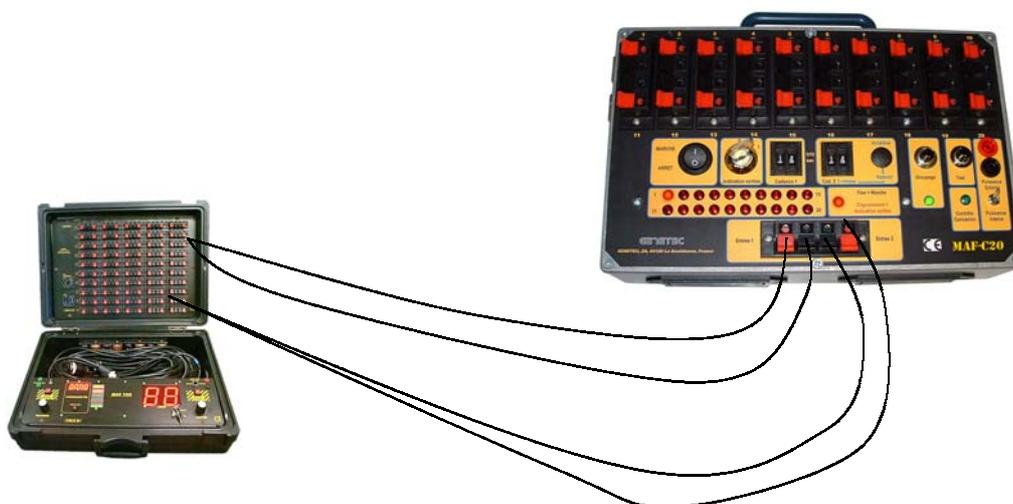
**Exemple 2** Connexion de deux séquenceurs en cascade à votre poste de tir
